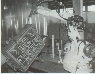
Der Roboter in Aktion: Schweissen eines Panzerdeckels.
