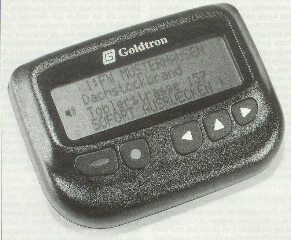
Ein alphanumerischer Pager des Typs GOLDTRON LEGEND 2000. Gute und zuverlässige Erreichbarkeit im Freien, in Gebäuden und auch Untergeschossen zeichnen dieses nur 75 Gramm schwere Modell aus. Der batteriebetriebene, vierzeilige Pager ist mit einer Standby-Zeit von drei Monaten und länger einer der besten seiner Klasse. Er ist für unter 400 Franken erhältlich und damit auch einer der günstigsten vergleichbaren Pager im Sicherheitsbereich.
