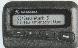
Alarmierung mit AUTOPAGE® auf Motorola-Pager Scriptor LX2 mit Ladegerät via TELEPAGE® swiss.
