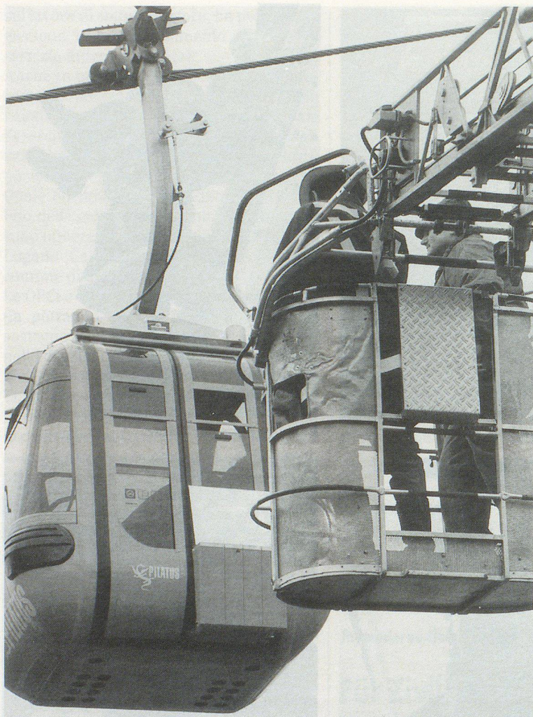
Ein Fall für die Feuerwehr: Bergung aus der Seilbahnkabine mittels Ausgleiter und Rettungskorb.
