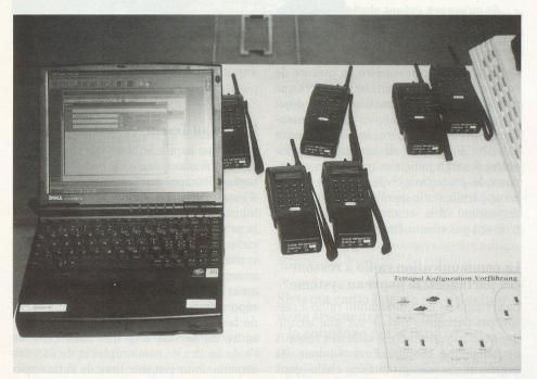
Auch das Anschliessen eines Notebooks an ein Bündelfunkgerät und damit die Übertragung von Daten und Telefax ist möglich.
