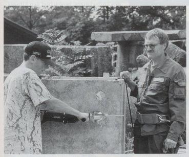
Instruktor Max Uehlinger überwacht die Handhabung der elektrischen Säbelsäge, die zum neuen Material gehört.
