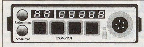
Das digitale Ansagegerät DA/M ist als Sprachspeicher für mobile Kommandoanlagen eine absolute Neuheit auf dem Schweizer Markt. Das Gerät eignet sich für den Einbau in Einsatzfahrzeugen der Feuerwehr, Polizei und beim Zivilschutz. Digitale Sprachspeicher ersetzen herkömmliche Kassettengeräte auf Komman-
