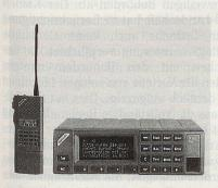
Moderne Hand- und Fahrzeugfunkgeräte, Fixstationen und Vermittlungseinrichtungen von Ascom Radiocom sind für Bündelfunk ausgelegt und anwenderspezifisch programmierbar.
