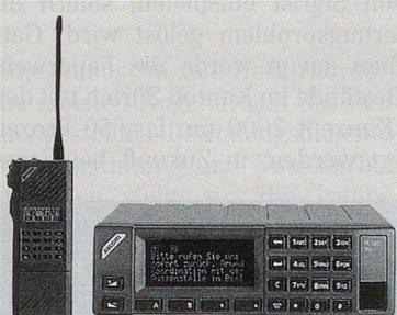
Moderne Hand- und Fahrzeugfunkgeräte, Fixstationen und Vermittlungseinrichtungen von Ascom Radiocom sind für Bündelfunk ausgelegt und anwender-spezifisch programmierbar.
