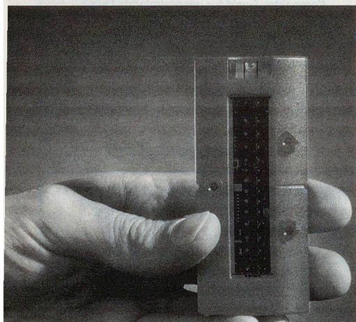
neue direkte Montagemöglichkeiten an Deckenkonstruktionen und Metallwänden, und auch der universelle Nivellierlattenhalter erweitert das Einsatzfeld. Mit zwei Mignonbatterien werden Betriebszeiten von gut 140 Stunden bzw. mit zwei Standardakkus etwa 50 Stunden erreicht.
