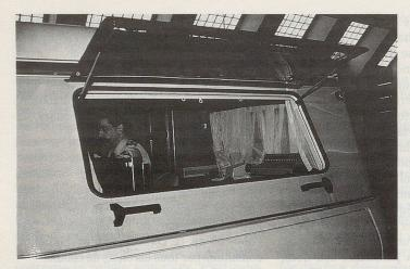
Le poste de commandement des interventions (PCI) est installé dans une caravanne qui peut se brancher directement sur le réseau téléphone.
