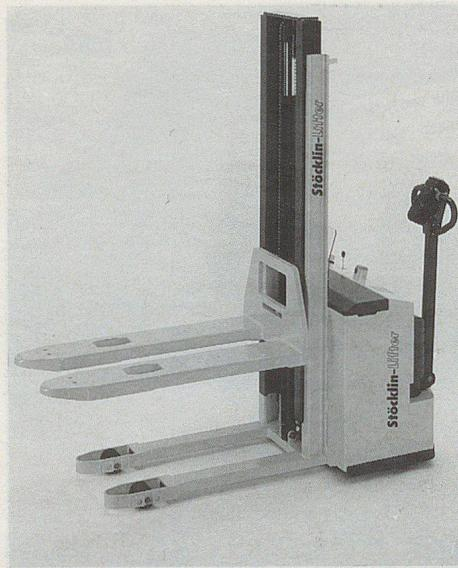
messen. Alle Fahrfunktionen können direkt vom Deichselkopf aus gesteuert werden, alle Bedienungselemente sind doppelt im Deichselkopf angeordnet.
