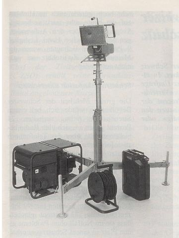
Beleuchtungsausrüstung (Notstromaggregat, Scheinwerfer, Zubehör).
