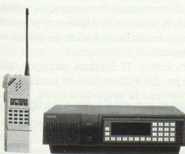
Moderne Hand- und Fahrzeugfunkgeräte, Fixstationen und Vermittlungseinrichtungen von Ascom sind für Bündelfunk ausgelegt und anwenderspezifisch programmierbar.
