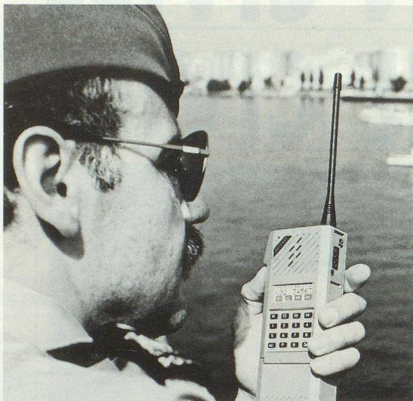
Wo immer vertrauliche oder geheime Informationen übermittelt werden müssen, besteht ein Risiko, dass diese vom Gegner abgefangen werden. Das neue Handsprechfunkgerät SE 160C mit digitaler Sprachverschlüsselung verhindert ein ungewolltes Abhören. Als modernes, mikroprozessorgesteuertes Gerät mit integriertem Verschlüsselungsmodul bietet es die erwünschte Sprachsicherheit und individuelle Anpassung an die Einsatzart. Lassen Sie sich über das SE 160C näher informieren.
