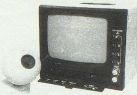
Sichere Zivilschutzanlagen. Keine Überraschung vor Eingängen oder Versorgungsanälen. Pro Monitor bis zu 4 Weitwinkel-Kugelkameras in wartungsfreier Chip-Technik. Auch mit Ton. Kabellängen bis 100 Meter. Mit Bildwechsel-Automatik und als Zubehör: Infrarot-Scheinwerfer. Ein robustes, professionelles und preisgünstiges System.
