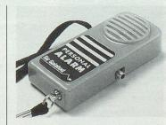
der Manteltasche wird er in der Hand gehalten und im Fall einer Gefahr mit Knopfdruck aktiviert. Wenn er in die Handtasche gesteckt wird, bleibt er durch eine Kordel mit dem Handgelenk verbunden. Der Alarm wird automatisch ausgelöst, wenn an der Tasche und damit an der Kordel gezogen wird. Das Gerät lässt sich aber auch an einer Türe befestigen und heult
