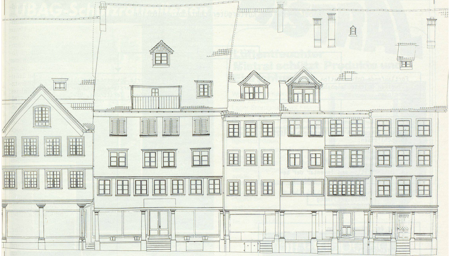
Der Ortskern von Lichtensteig. Auf der photogrammetrischen Aufnahme ist jedes Detail zu erkennen.
