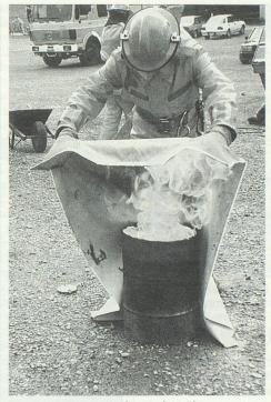
Einsatz mit einer geprüften und zugelassenen gasdichten Löschdecke.
