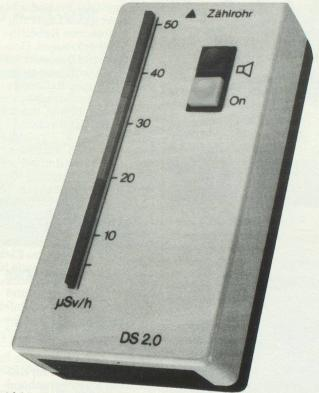
Dosisleistungsmessgerät DS 2.0.
