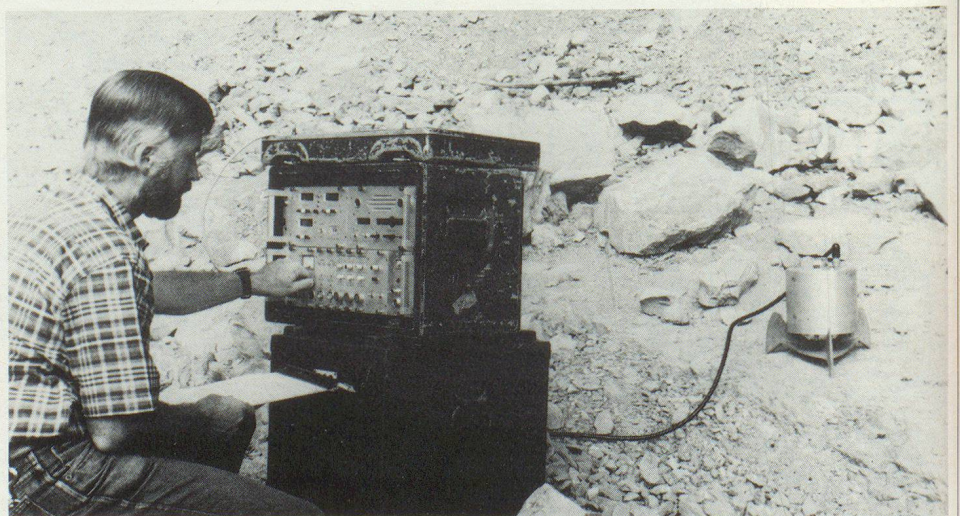
Das Ohr am Puls der Erde: Messgerät zum Erfassen schwacher Erschütterungen des Gesteinsuntergrundes.
