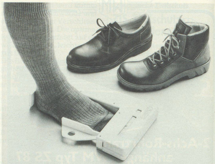
Bürgt für individuelle Passform: Das Fussmessgerät von Otter-Schuhe hält die individuellen Längen- und Weitenwerte des Fusses fest. Damit kann der passgenaue Otter-Mondopoint-Schutzschuh ausgewählt werden. Allerdings: Ohne vorheriges Messen geht es nicht. (Foto: Otter-Schuhe)
