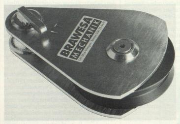
neue Stahlseitenwände und einem massiven Verschlussbolzen erreicht. Die optimale Seilauflage erfolgt auf der wälzgelagerten, leichtgängigen Stahlrolle. Die Brawesa Seilrolle ist abgedichtet, korrosionsgeschützt und dauergeschmiert und daher praktisch wartungsfrei. Alle Teile sind auswechselbar und als Ersatzteil einzeln erhältlich. Die neuen Brawesa-Seilrollen werden in sieben Baugrössen von 1 bis 5 Tonnen Tragkraft fabriziert.
