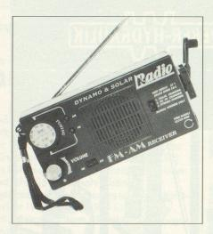
Schutzraumradio UKW/MW mit Handkurbel und Solarzellen
