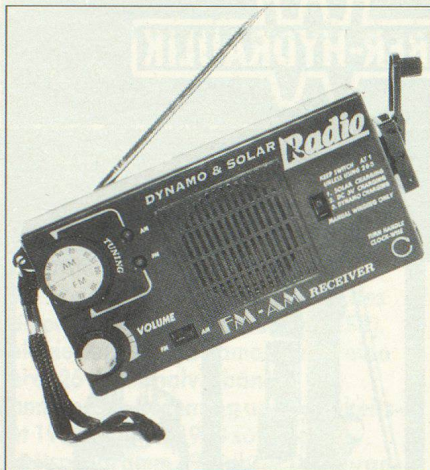
Schutzraumradio UKW/MW mit Handkurbel und Solarzellen
