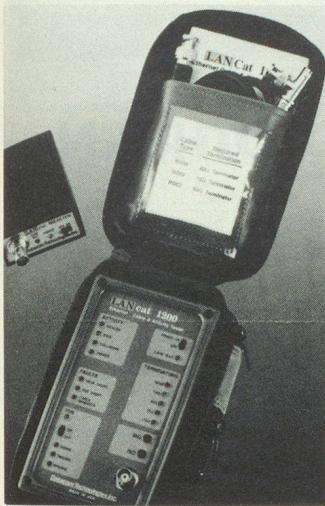
gebrochene Kabel erkennt der Kabeltester Lancat 1200 für Netzwerke von Alpha-Beta Electronics.
