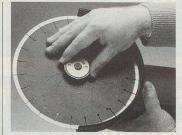
«Kwik-lock-System»: So einfach war das Scheibenwechseln bei einem Trennschleifer noch nie. Ein Schlüssel zum Lösen der Spannmutter ist nicht mehr erforderlich.
