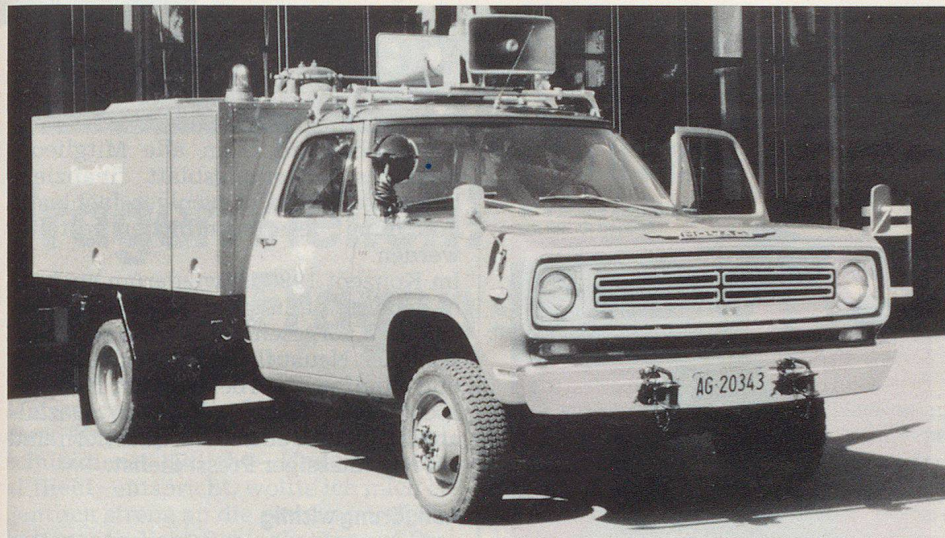
Feuerwehrfahrzeug mit montierter mobiler Sirene.
