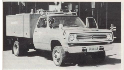
Feuerwehrfahrzeug mit montierter mobiler Sirene.
