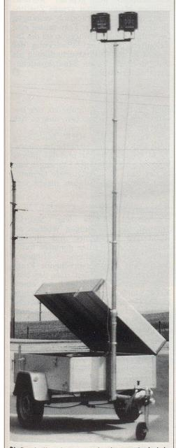
Die Beschaffung besserer Beleuchtungsmittel wird ständig geprüft. Bild: Ein Hochintensiv-Flutlichtscheinwerfer mit Halogenmetalldampf-Lampen, ideal zur Ausleuchtung von Schadenplätzen. Werkfoto: City-Licht AG, Zürich
