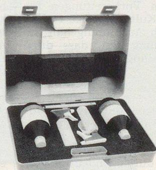
Die Dichtigkeitsprüfung mit dem ICB-Prüfset ist harmlos und empfindlich, auch geringe Undichtigkeiten werden zuverlässig aufgezeigt.
