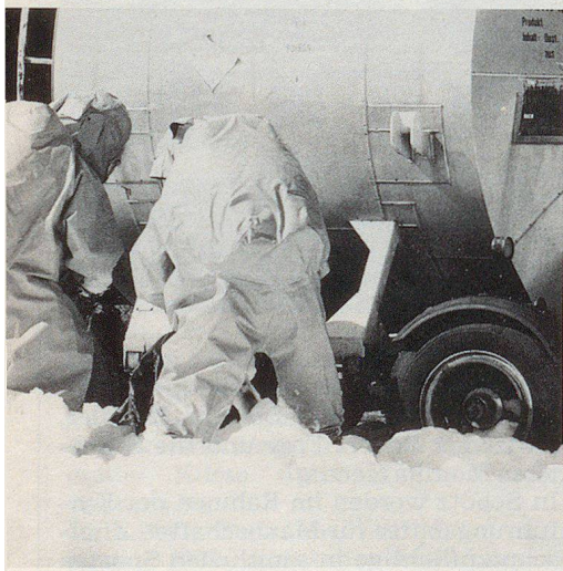
Umpumpen einer feuergefährlichen Flüssigkeit. Zuvor wurde Schaum eingesetzt.
