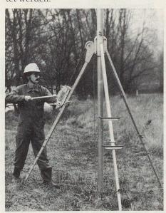
Abb. 8. Stativ mit Hebe- und Senkvorrichtung.
