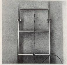
Abb. 12. Aussenantenne zu E-662 im Notausstieg.
