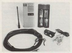
Abb. 11. Schutzraumempfänger E-662 mit Zubehör.
