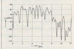
Abb. 16. Pegelverteilung im Inneren eines Schutzraumes.
