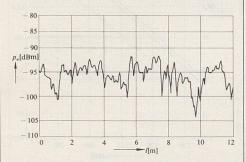
Abb. 17. Pegelverteilung im Inneren eines Schutzraumes wie in Abb. 16, jedoch bei Belegung mit Personen.
