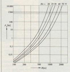
Abb. 18. Benötigte Sendeleistung Ps in Abhängigkeit vom Versorgungsradius R für verschiedene Antennenhöhen Hs.
