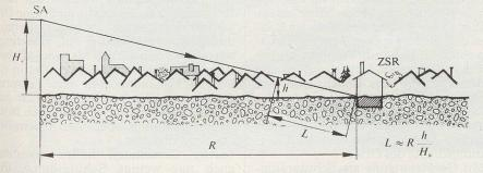
Abb. 14. Der Strahlenweg zwischen der Sendeantenne und dem Schutzraum, behindert durch die Häusermasse.
