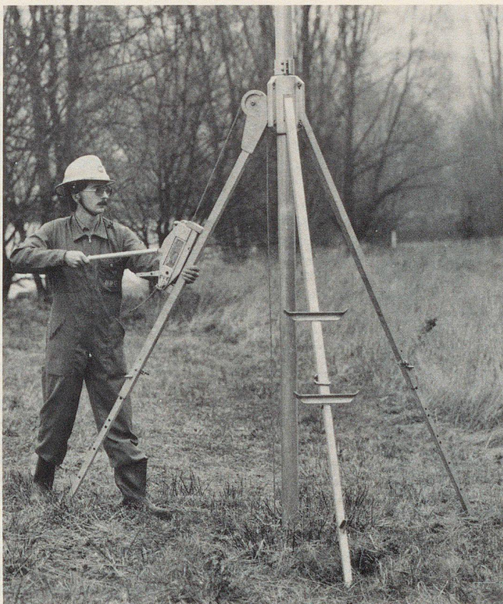
Statif avec élévateur de tube du mât d'antenne A-362.
