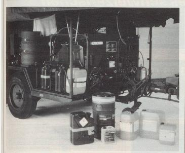
Für den autarken Betrieb des decojet®-trailers werden alle notwendigen Dekont-Chemikalien mitgeführt. Calciumhypochlorit Tetra mit Emulgator (ent-giften/entseuchen) RM 54 + Kalkstabilisator (entstrahlen/reinigen) RM 21 (Personendusche/reinigen) RM 35 (desinfizieren).
