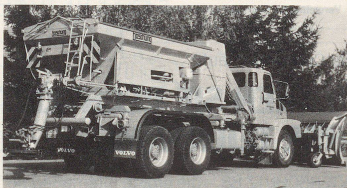
6-m³-Aufsatzstreuautomat mit Feuchtsalzeinrichtung. Abrollkipper-System. Autobahnschneepflug Typ MF mit Windleitschirm.
