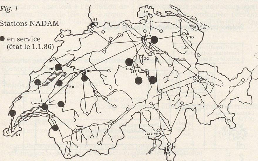
Réseau automatique de mesure pour l'alarme radioactivité (NADAM)
