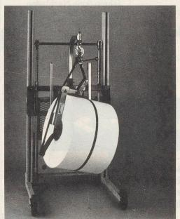
Kleinstapler mit patentierter Breitenverstellung und Greifvorrichtung für Rollenmaterial mit automatischer Anpassung an den Rollendurchmesser. (Foto: FTA Fahrzeugtechnik AG, 5035 Unterentfelden).
