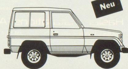
**Landcruiser II 4 x 4 Hard- und Soft-Top:** 3 Türen, 5 Plätze, 4-Zylinder-Dieselmotor, 2446 cm<sup>3</sup>, 53 kW (72 PS) DIN, 5-Gang-Getriebe, jederzeit zuschaltbarer Allradantrieb, Geländeunterstützung auf allen Gängen, Sperrdifferential und Freilaufnaben, Servolenkung, Nutzlast 420 kg resp. 450 kg, geprüfte Anhängelast 3000 kg. Ab **Fr. 27 950.—**
