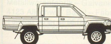
**Hilux 4 x 4:** 5-Gang-Getriebe, jederzeit zuschaltbarer Allradantrieb, Gelände-Untersetzung auf allen fünf Gängen und Sperrdifferential hinten. Mit 4-Zylinder-Benzinmotor: 1998 cm<sup>3</sup>, 65 kW (88,4 PS) DIN. Nutzlast 1135 kg. Lieferbar als Chassis-Kabine, Pickup oder mit Doppelkabine (4-Gang-Getriebe). Ab **Fr. 21 200.—** Pickup auch mit Dieselmotor (2446 cm<sup>3</sup>) und 1020 kg Nutzlast. Ab **Fr. 23 990.—** Chassis-Kabine (Benzin) mit CH-Alubrücke: Bundessubvention **Fr. 4500.—**
