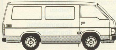
**Hiace 1800:** kurzer Radstand, 4-Zylinder, 1812 cm<sup>3</sup>, 58 kW (79 PS) DIN, 5-Gang-Getriebe mit Sperrdifferential. Als Kastenwagen, Kombi Minibus und Schulbus (2 + 21 Personen) lieferbar. 3/6/9/11/13/14 Plätze, Nutzlast bis zu 1170 kg. Ab **Fr. 19 350.—** (Auf Wunsch auch 2-Liter-Motor und Automat.)
