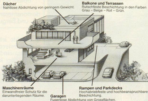
Das «Scotch Clad» DECK COATING SYSTEM ist eine flüssig aufzutragende, durch Luftfeuchtigkeit härtende Einkomponenten-Beschichtungsmasse auf der Basis von Polyurethan sowie 3M-eigenen Rohstoffen.
