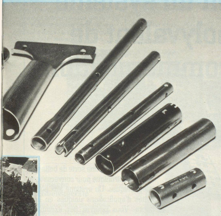
Eine Spezialität – stanztechnisch gefertigte Rohre.
