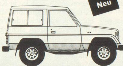
**Landcruiser II 4 x 4 Hard- und Soft-Top:** 3 Türen, 5 Plätze, 4-Zylinder-Dieselmotor, 2446 cm<sup>3</sup>, 53 kW (72 PS) DIN, 5-Gang-Getriebe, jederzeit zuschaltbarer Allradantrieb, Geländeunterersetzung auf allen Gängen, Sperrdifferential und Freilaufnaben, Servolenkung, Nutzlast 420 kg resp. 450 kg, geprüfte Anhängelast 3000 kg. Ab **Fr. 27 950.—**
