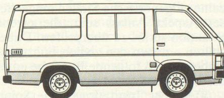
**Hiace 2000:** langer Radstand, 4-Zylinder, 1998 cm<sup>3</sup>, 65 kW (88,4 PS) DIN, 5-Gang-Getriebe oder auf Wunsch mit Automat oder auch mit Dieselmotor (2445 cm<sup>3</sup>), mit Sperrdifferential. Als Kastenwagen, Kombi, Wagon und Schulbus (2 + 23 Personen) lieferbar. 3/6/9/11/14/15/16 Plätze, Nutzlast bis 1220 kg. Ab **Fr. 20 150.—**
