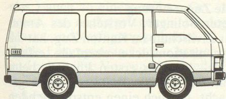
**Hiace 1800:** kurzer Radstand, 4-Zylinder, 1812 cm<sup>3</sup>, 58 kW (79 PS) DIN, 5-Gang-Getriebe mit Sperrdifferential. Als Kastenwagen, Kombi Minibus und Schulbus (2 + 21 Personen) lieferbar. 3/6/9/11/13/14 Plätze, Nutzlast bis zu 1170 kg. Ab **Fr. 19 350.—** (Auf Wunsch auch 2-Liter-Motor und Automat.)
