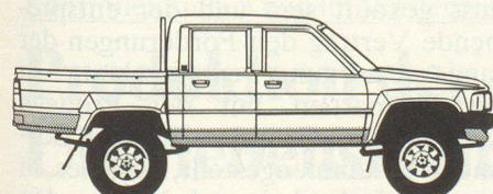
**Hilux 4 x 4:** 5-Gang-Getriebe, jederzeit zuschaltbarer Allradantrieb, Gelände-Untersetzung auf allen fünf Gängen und Sperrdifferential hinten. Mit 4-Zylinder-Benzinmotor, 1998 cm<sup>3</sup>, 65 kW (88,4 PS) DIN. Nutzlast 1135 kg. Lieferbar als Chassis-Kabine, Pickup oder mit Doppelkabine (4-Gang-Getriebe). Ab **Fr. 21 200.—** Pickup auch mit Dieselmotor (2446 cm<sup>3</sup>) und 1020 kg Nutzlast. **Fr. 23 990.—**
