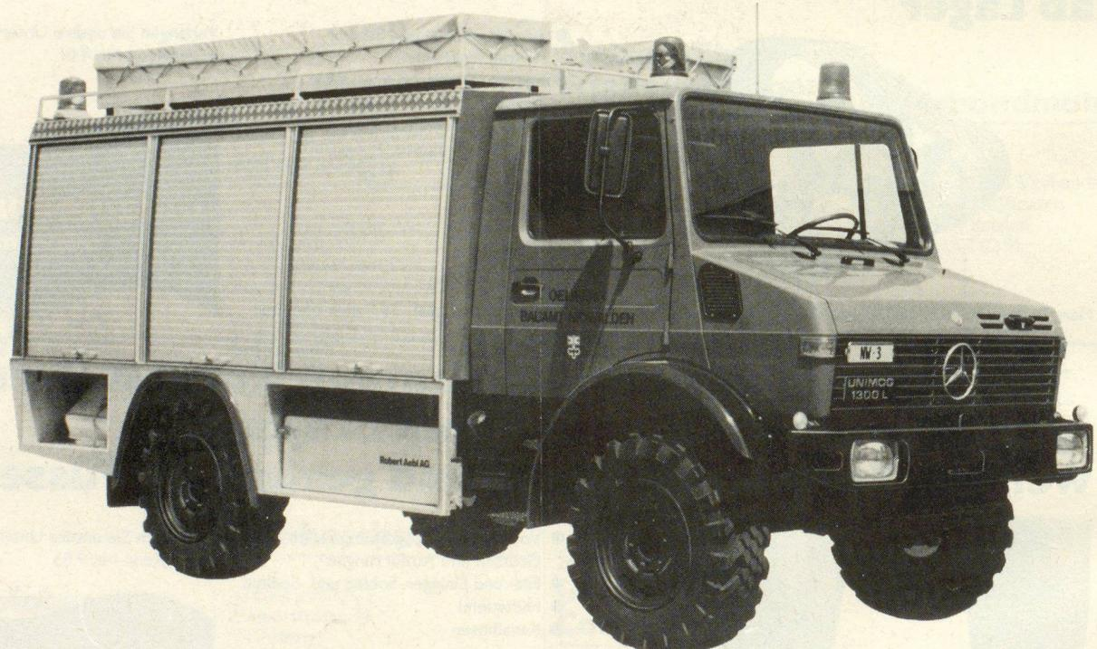
In grossen Serien produziertes Fahrzeug. Unübertraffen im Gelände. Schnell auf der Strasse. 6-Zylinder-Dieselmotor mit 168 DIN-PS. Leistungsverhältnis 21 DIN-PS/t.
