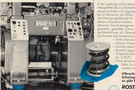
In der Lagerung von hochempfindlichen Messgeräten bis zu schwersten Werkzeugmaschinen und Aggregaten ist Vibrachoc der führende Schwingungsdämpfer für aktive und passive Isolation. Vibrachoc hat als einziger ein gewirktes, gewelltes Chromstahldraht-Kissen als Dämpfer.
