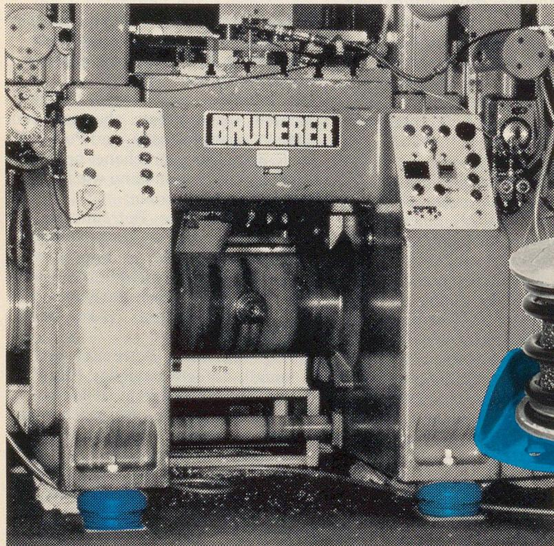
In der Lagerung von hochempfindlichen Messgeräten bis zu schwersten Werkzeugmaschinen und Aggregaten ist Vibrachoc der führende Schwingungsdämpfer für aktive und passive Isolation. Vibrachoc hat als einziger ein gewirktes, gewelltes Chromstahldraht-Kissen als Dämpfer. Die Vorteile sind bestechend:
