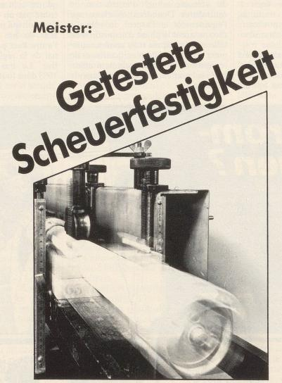
Die «Abnutzungsmaschine», eine Eigenkonstruktion: Hartmetallmesser scheuern unter Druck auf dem Schlauch, bis dieser platzt.
