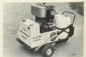
K.E.W.-Hochdruckreiniger Typ CD 150 mit Dieselmotor und Batteriestarter, 6-Zylinder-Hochdruckpumpe mit einer Ausgangsleistung von 4,1 kW (150 bar bei 16,4 l/min), Ersatzhochdruckschlauch, Saugschlauch mit Spezialfilter usw. Kosten: etwa 9000 Franken.
