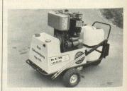
K.E.W.-Hochdruckreiniger Typ CD 150 mit Dieselmotor und Batteriestarter, 6-Zylinder-Hochdruckpumpe mit einer Ausgangsleistung von 4,1 kW (150 bar bei 16,4 l min), Ersatzhochdruckschlauch, Saugschlauch mit Spezialfilter usw. Kosten: etwa 9000 Franken.
