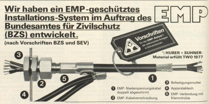
Durch **Abschirmung** und **Ableitung** des bei einer atomaren Explosion entstehenden EMP-Stosses **verhindert** das **HUBER** + **SUHNER**-System **Schäden** an den elektrischen Anlagen, sowohl beim Normal- als auch beim Notstrombetrieb.
