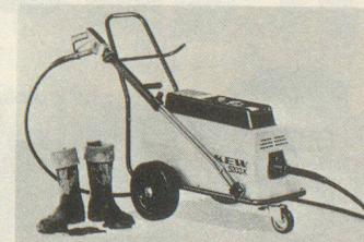
Nachdem Reinigung wertehaltend wirkt, das heißt vor dem Zerfall zu schützen vermag, hat die Hochdrucktechnik einen wichtigen Platz beim Unterhalt von Gebäuden (Dächern, Fassaden, usw.), der Reinigung von Denkmälern und Kulturgütern, welche oft unter einer Schicht von Russ und Staub zugrunde gingen.
