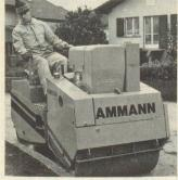
Neu: Ammann-Tandem-Doppelvibrationswalzen DTV-222, vollhydrostatischer Fahr- und Vibrationsantrieb. Einsatzgewicht: 2350 kg. Für mittlere Bau- und Instandstellungsobjekte.
