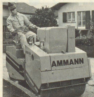
Neu: Ammann-Tandem-Doppelvibrationswalzen DTV-222, vollhydrostatischer Fahr- und Vibrationsantrieb. Einsatzgewicht: 2350 kg. Für mittlere Bau- und Instandstellungsobjekte.
