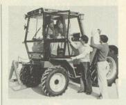
über 70 verschiedenen Anbaugeräten eingesetzt werden (Strassenreinigung, Winterdienst, Forstwesen, Kanalisationsreinigung, Transport, Landschaftspflege usw.). Zusätzlich verfügt dieses System über drei Anbauräume - vorn, zentral, hinten - und erlaubt dadurch unzählige Gerätekombinationen
