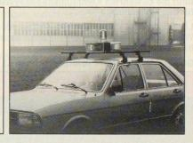
Mit 2 oder 4 Lautsprechern, mit oder ohne Blaulicht, für 4 verschiedene Alarmsignale und Sprachdurchsage, für Kernkraftwerke, Zivilschutz, Feuerwehr, Polizei und Armee.
