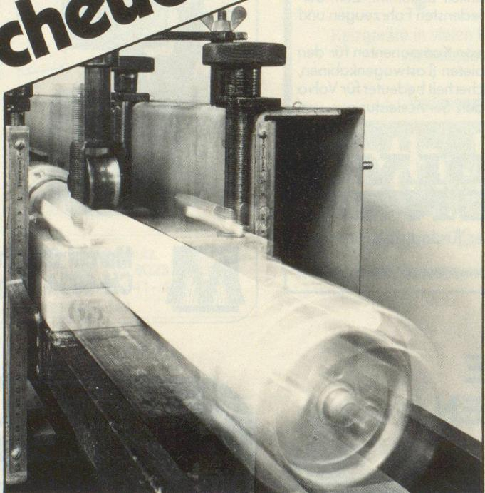
Die «Abnutzungsmaschine», eine Eigenkonstruktion: Hartmetallmesser scheuern unter Druck auf dem Schlauch bis dieser platzt.
