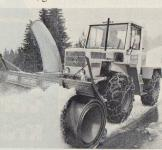
Abb. 2. MB-trac von Daimler-Benz, ein überwiegend aus erprobten Unimog-Aggregaten konzipierter Allradschlepper, mit Vorbau-Schneefräse. (Robert Aebi AG, Zürich)
